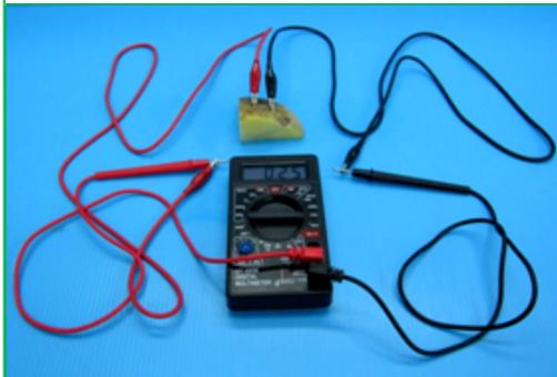
圖 2 電阻測量的電路圖
