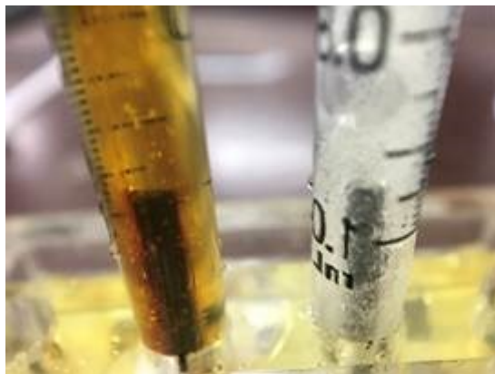
图 14 0.5 M KI 溶液 9 滴 加入 30 滴 BTB 指示剂
