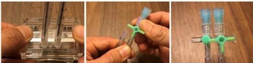
針筒壓柄與電解槽的橢圓形凹陷處接合
