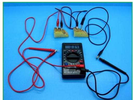
5. 使用第一條鱷魚夾電線，一端夾住第一個馬鈴薯電池的華司(-)，另一端夾住第二個馬鈴薯電池的硬幣(+)，形成兩個串聯的馬鈴薯電池。
