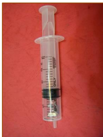
相片九：鎂帶放入注射筒中後再將活塞塞入注射筒中
