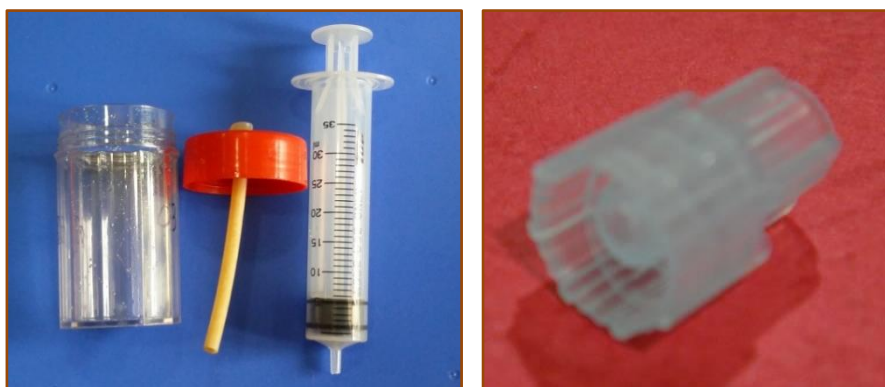
相片三：塑膠罐、橡皮管、塑膠注射筒 (左) 及單孔塑膠塞 (右)
