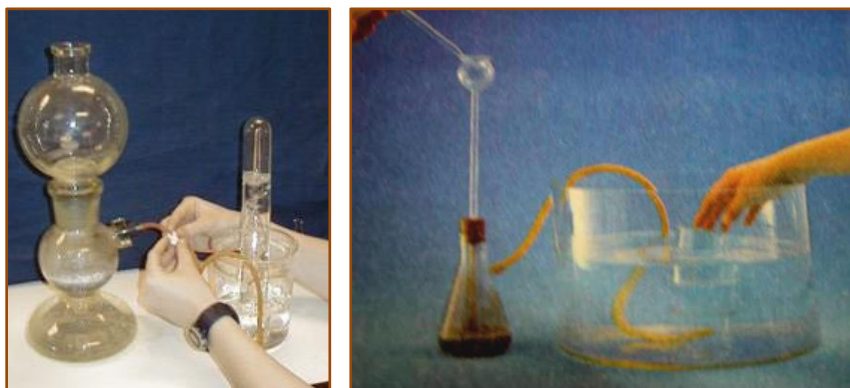
相片一：啟普式氣體製備裝置 (左)，傳統排水集氣法 (右)
