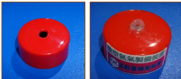
相片四：蓋子中央小孔 (左) 及單孔塑膠塞用熱熔膠固定 (右)
