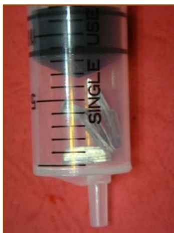
相片九：鎂帶放入注射筒中後再將活塞塞入注射筒中
