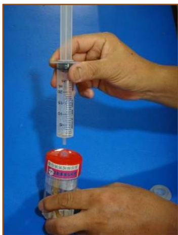
相片十五：將注射筒拔離塑膠罐
