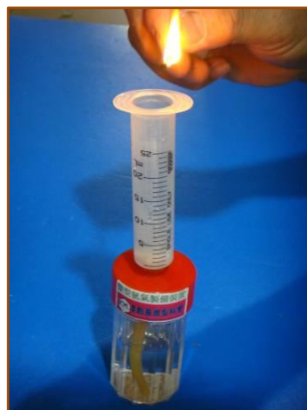
相片十三：點燃的火柴水平靠近注射筒口
