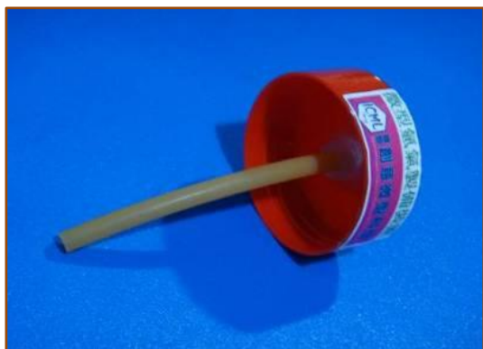
相片五：單孔塑膠塞下方接橡皮管
