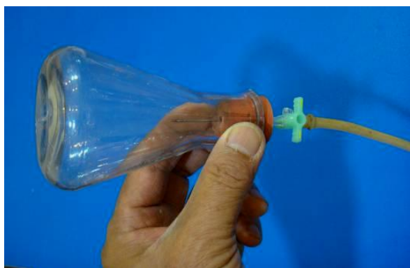
相片八：橡皮塞塞在塑膠三角瓶的瓶口
