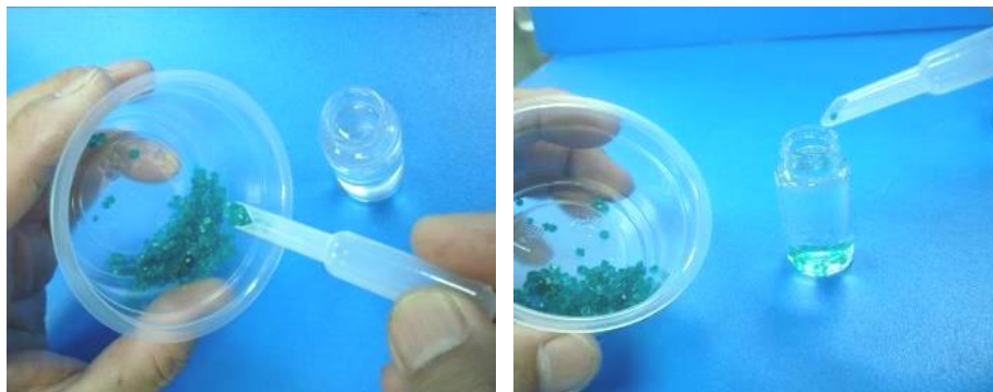
相片五：加一小刮杓的硫酸鎳晶體到水玻璃溶液中
