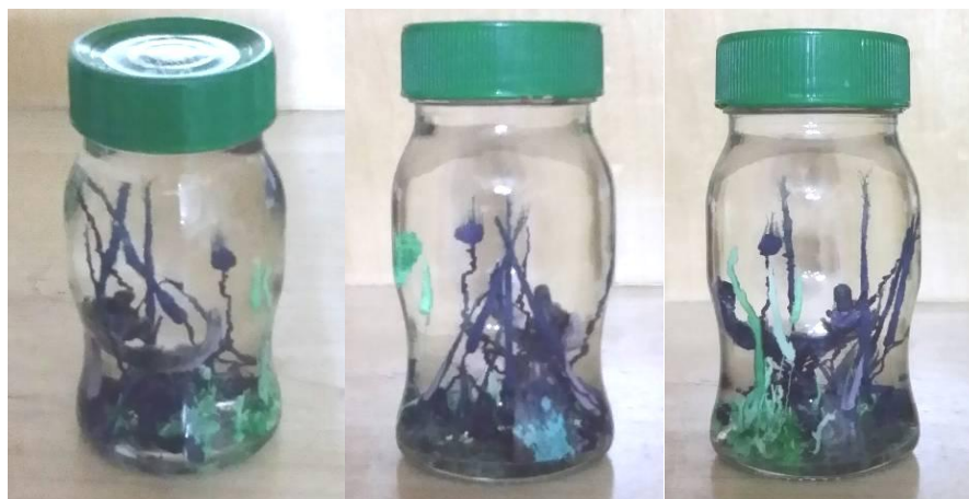
相片十：三種不同過渡金屬鹽類在水玻璃溶液中生長的形狀
