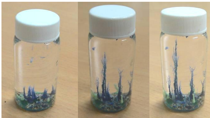
相片八：過渡金屬鹽類在水玻璃溶液中 不同時間內之成長情形
