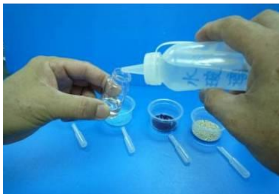
相片二：玻璃瓶內倒入少量的水玻璃
