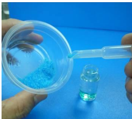
相片四：加一小刮杓的硫酸銅晶體到水玻璃溶液中
