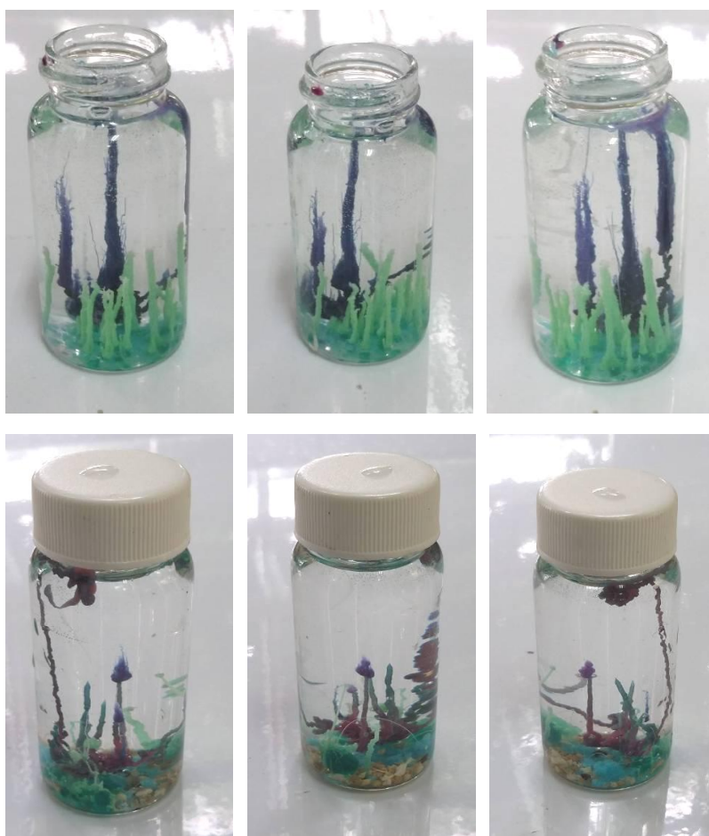
相片十：三種不同過渡金屬鹽類在水玻璃溶液中生長的形狀
