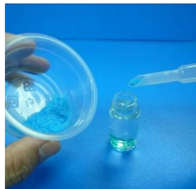
相片四：加一小刮杓的硫酸銅晶體到水玻璃溶液中
