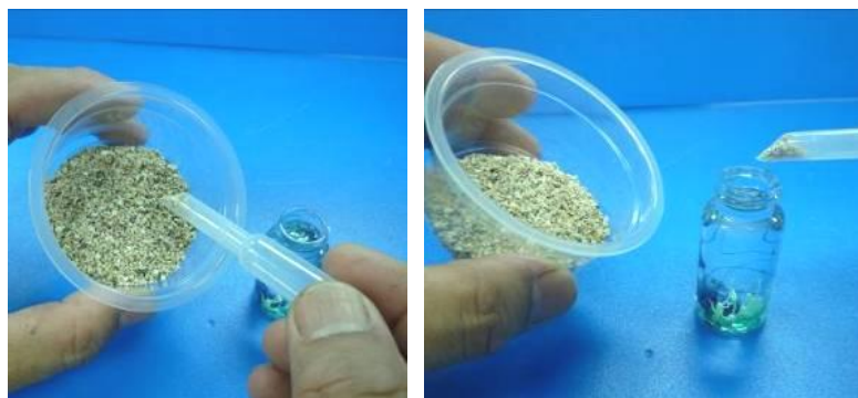
相片七：加一小刮杓的細沙到水玻璃溶液中
