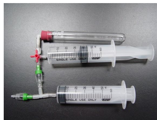
圖 4b: 混合氣體移入試管裝置圖
