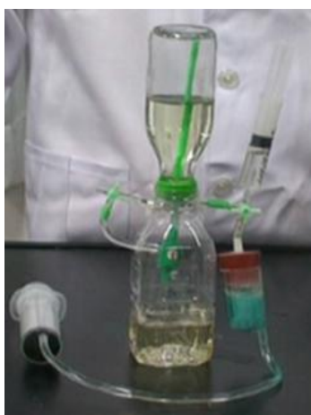
圖 5a：NO 與 NO 2 氣體密閉系統實驗裝置
