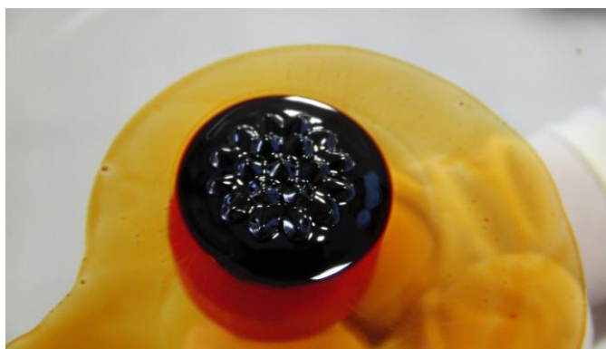
圖 2：磁性流體的突出峰效應明顯，具有良好的流動性。
