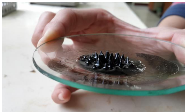
圖 6：鐵磁流體在強力磁鐵的作用下產生的突出峰。
