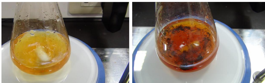
圖 4：滴入氨水前溶液的顏色(左)，滴入氨水後溶液中有黑色生成物(右)。
