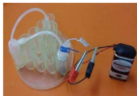
相片十二：用乾電池之直流電源進行電解
