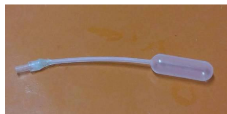
相片三：小塑膠接頭接在 塑膠細長型滴管之前端
