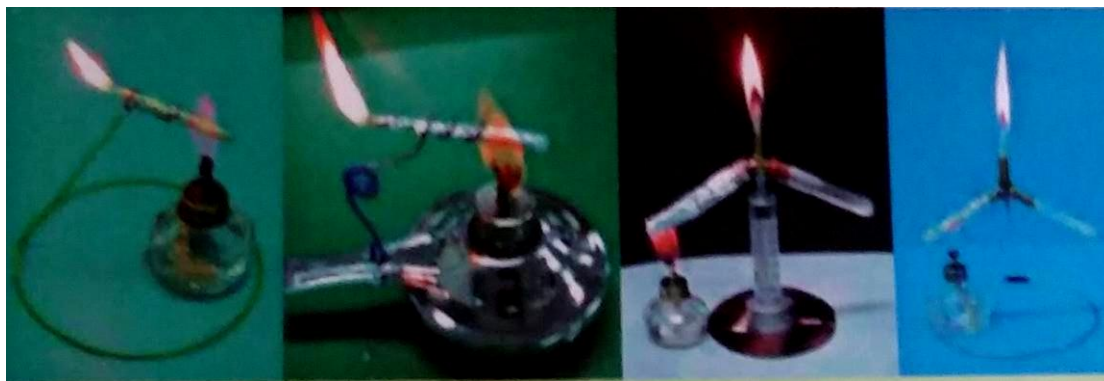
相片十五：前完成使用酒精燈加熱之微型木材乾餾裝置
