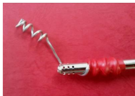
相片三：鋁線圈的套入瓦斯點火器的前端
