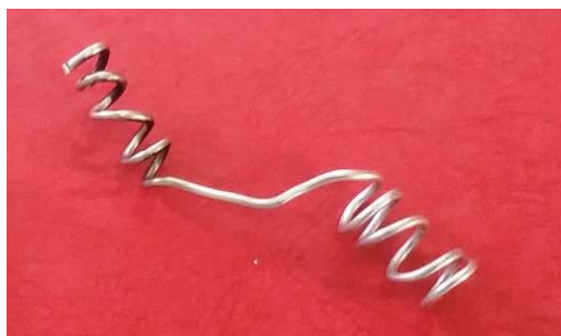
相片二：兩端捲成螺旋狀之鋁線圈
