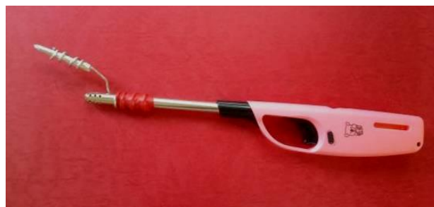
相片四：組裝完成之「微型木材乾餾裝置」
