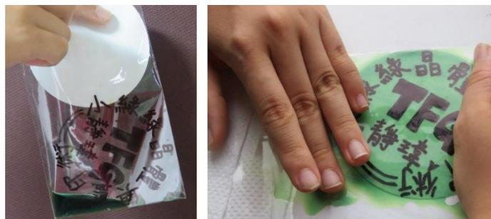
圖 10：晒圖濾紙浸泡印料：將一張濾紙小心放入遮光罩的袋內（左）；將多餘的液體從袋口排到紙巾裡（右）。
