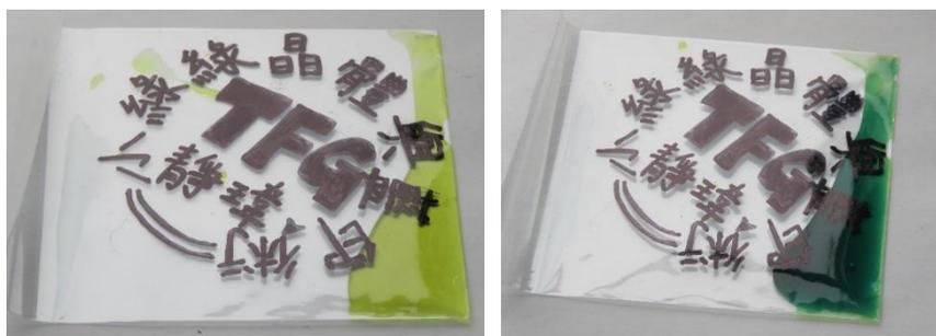
圖 9：晒圖藍印法的印料製作：先將赤血鹽與醋酸混合（左）；尋找室內比較暗的地方，再加入草酸鐵鉀（小綠綠）溶液（右）。
