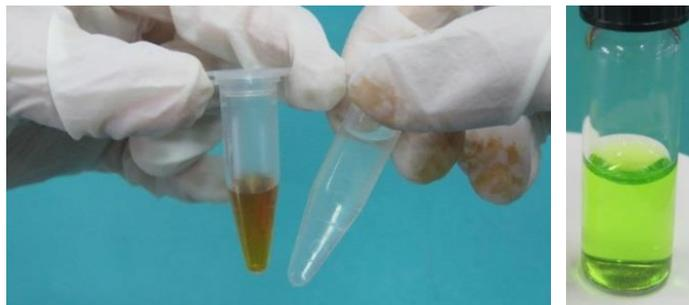
圖 2： $K_2C_2O_4$  與  $FeCl_3$  的混合：左為  $FeCl_3$  溶液，右為  $K_2C_2O_4$  溶液（左）；錯合反應產生綠色的  $[Fe(C_2O_4)_3]^{3-}$  離子（右）。
