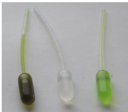
圖 5：藍印配方的原料：左為赤血鹽溶液，中為醋酸溶液，右為草酸鐵鉀飽和溶液。
