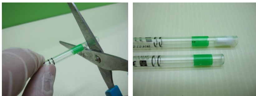
圖五：剪掉移液管的後端（左）；剪掉棉花部分的移液管（右）
