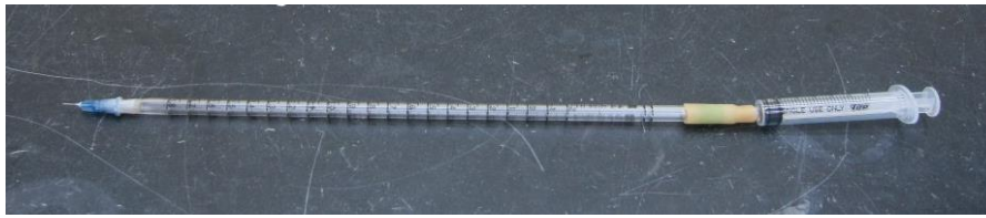
圖十一：完成的微量滴定管，針筒直接緊密套住移液管（上）； 針筒與移液管之間用橡皮管緊密接合（下）
