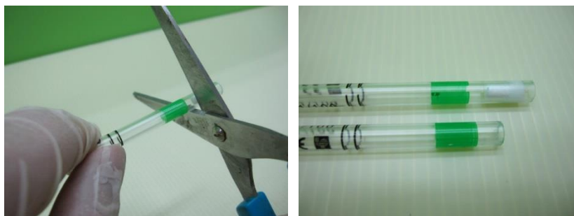
圖五：剪掉移液管的後端（左）；剪掉棉花部分的移液管（右）
