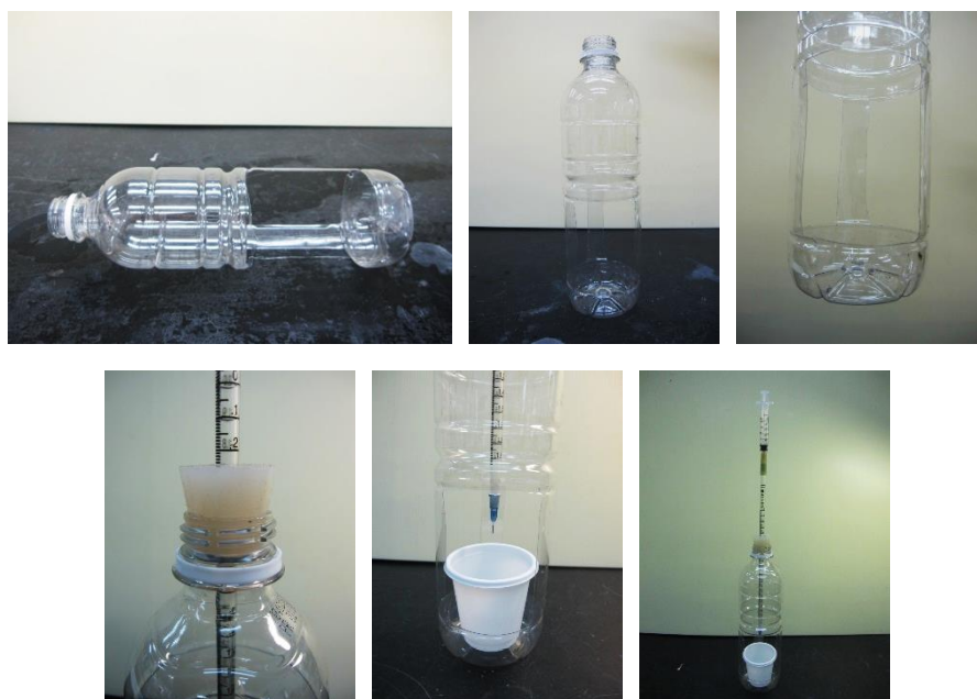
圖十二：保特瓶下半瓶身被減成三個大孔洞（上）；微量滴定管插入橡皮塞中（左下）；調整合適位置（中下）；微量滴定管固定架（右下）
