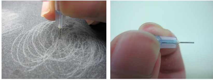
圖五：用磨砂紙磨平針頭的開口（左）；磨平的針頭（右）
