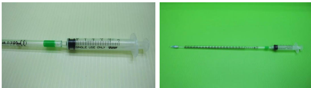
圖八：針筒的前端直接插入移液管的後端開口（左）；組裝完成的一支微量滴定管（右）
