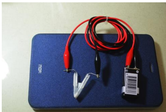
圖五：接上鱷魚夾導線及電池
