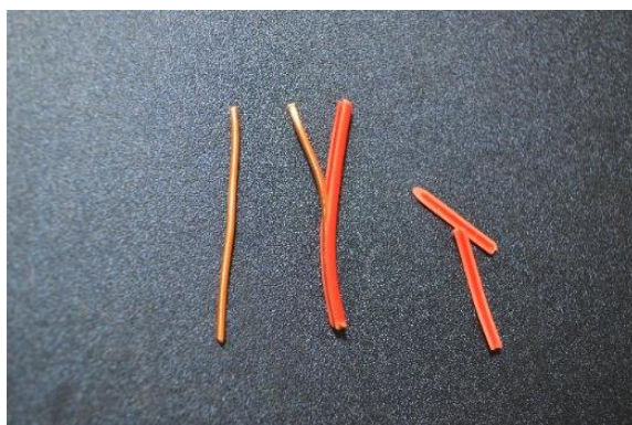
圖六：剝去銅導線的塑膠外皮，取得銅棒
