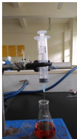
圖二：精稱碘酸鉀、過量碘化鉀及硫酸加入錐形瓶中形成三碘離子紅棕色溶液
