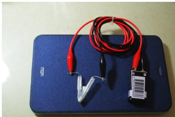
圖五：接上鱷魚夾導線及電池
