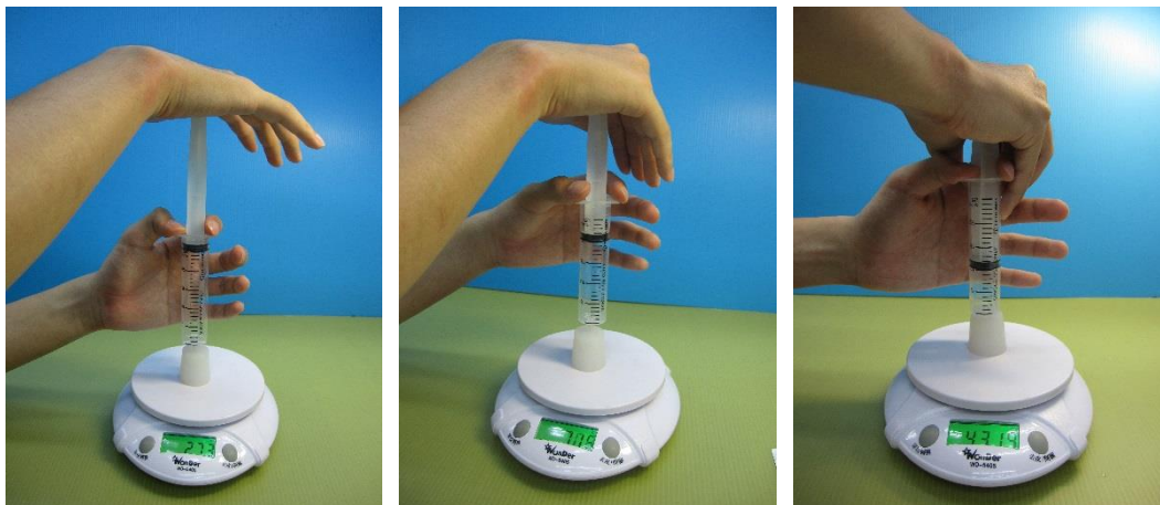
圖十三：由左而右，對料理秤的施力需要越來越大
