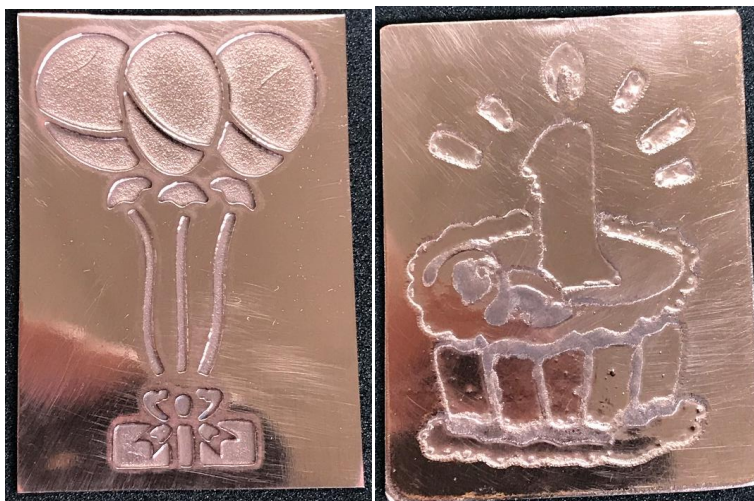
圖 8：蝕刻作品：使用氯化鐵溶液（左）和雙氧水加 EDTA-4Na 混合溶液（右）
