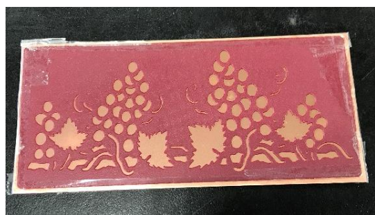
圖 4：金屬前、後面圖案外的空白處皆以透明膠帶黏貼密封
