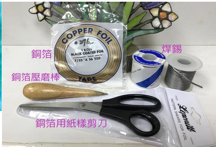
圖四：製作鑲嵌玻璃包覆玻璃的銅箔、銅箔壓磨棒、剪透明片用的銅箔用紙樣剪刀與焊接用的焊錫
