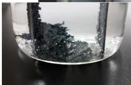
圖 1 電鍍實驗中陰極電鍍層金屬剝落的
