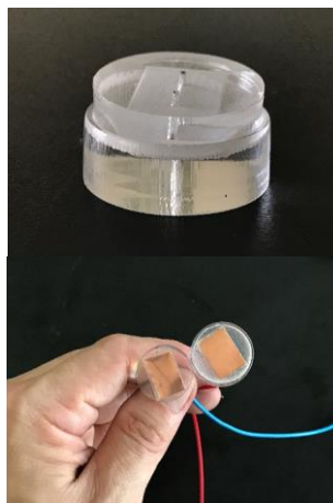
圖 4 穿線前後的壓克力載台及完成裝置圖
