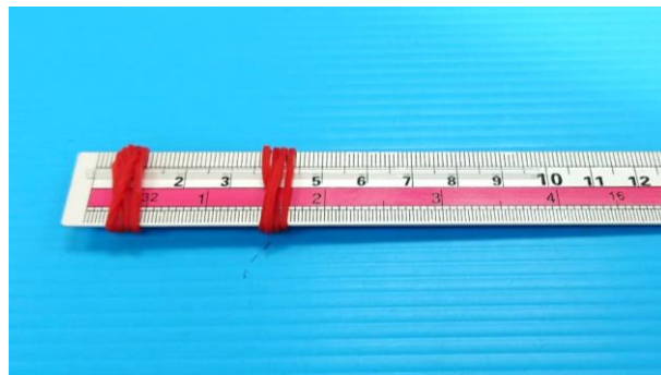
圖三：用兩條橡皮筋固定毛細管在金剛尺上
