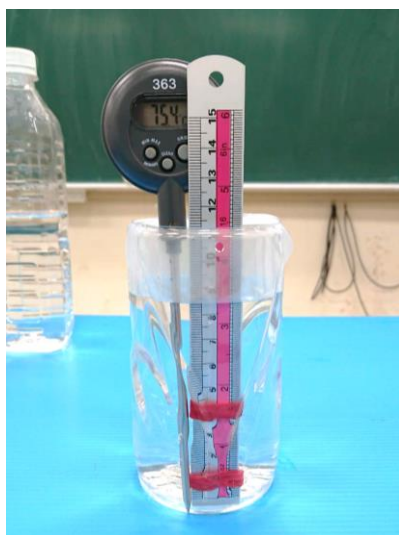
圖六：正式測量前，先調整水溫在 60-75°C 之間
