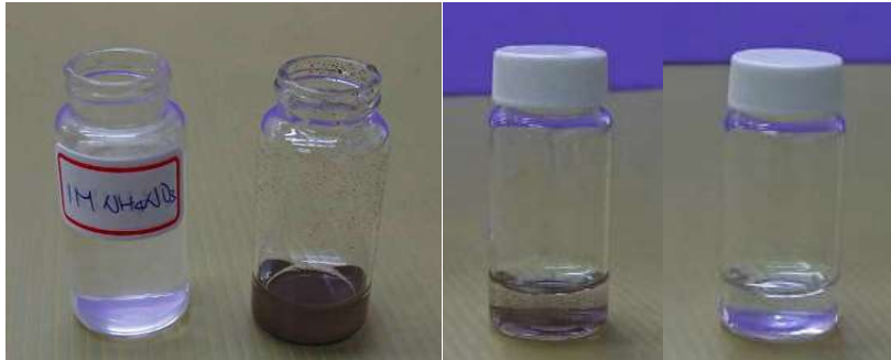
圖五：小玻璃瓶內然後滴入硝酸鉍溶液（左）；繼續滴入硝酸鉍溶液（中）；直到溶液變回透明澄清（右）。
