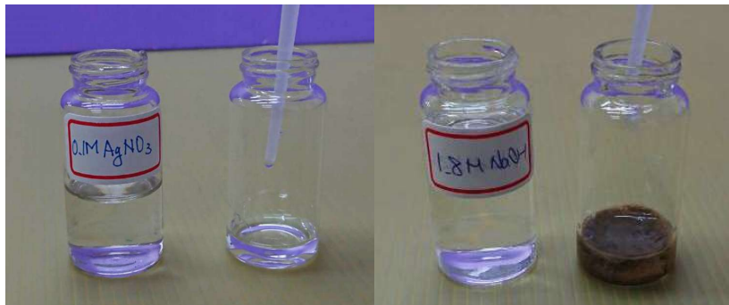
圖四：小玻璃瓶內裝硝酸銀溶液（左）；再滴加氫氧化鈉溶液（右）。
