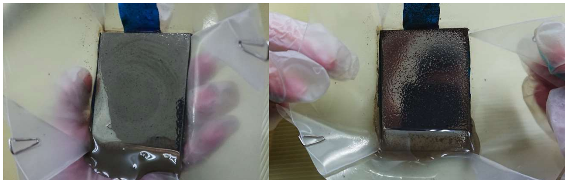
圖七：搖晃使玻璃面與反應溶液均勻接觸（左）；搖晃至混合溶液呈現接近透明（右）。
