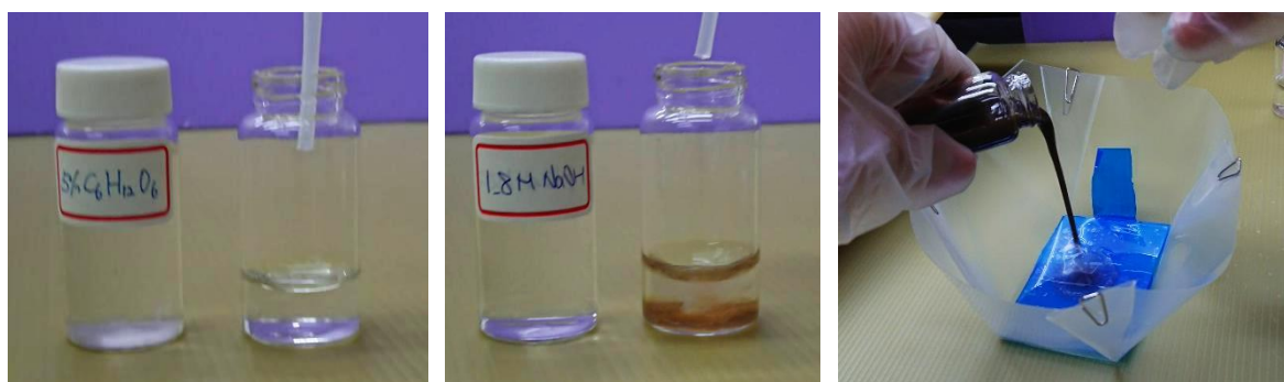
圖六：在小玻璃瓶內快速地滴入葡萄糖溶液（左）；再快速地滴入氫氧化鈉溶液（中）；以及迅速地倒入塑膠反應槽內（右）。
