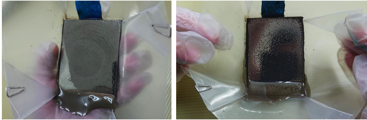
圖七：搖晃使玻璃面與反應溶液均勻接觸 (左)；搖晃至混合溶液呈現接近透明 (右)。
