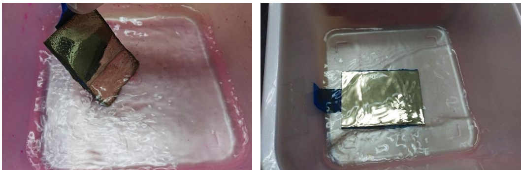
圖八：取出玻璃片，放到水槽中潤洗 (左)；再放到 95% 酒精的小塑膠盆中潤洗 (右)。
