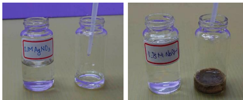
圖四：小玻璃瓶內裝硝酸銀溶液（左）；再滴加氫氧化鈉溶液（右）。
