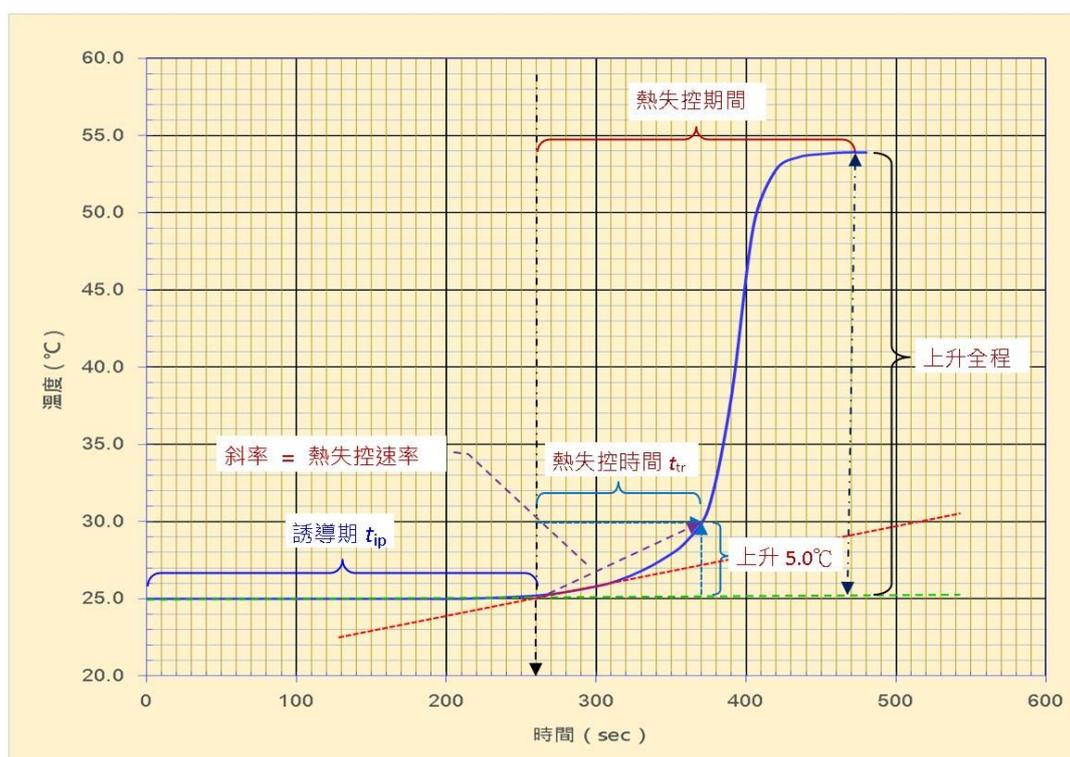
圖一：熱失控誘導期和熱失控速率的典型圖
