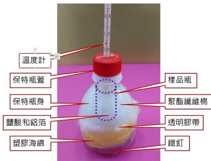
圖二：反應裝置及其各材料的名稱，放置鹽酸和鋁箔之處。
