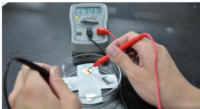
圖 2：微型電化學電位差的量測過程
