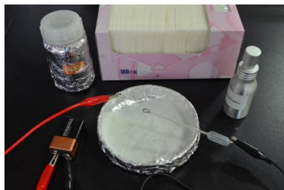
圖 6：微型電解池電解筆的製作組裝圖
