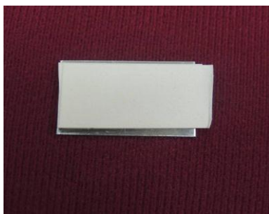
圖 3：金屬片上面放置已浸泡電解質的濾紙 ( 左 ) 和再放置金屬片並用綁緊兩金屬片 ( 右 )
