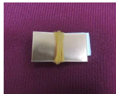
圖 3：金屬片上面放置已浸泡電解質的濾紙 ( 左 ) 和再放置金屬片並用綁緊兩金屬片 ( 右 )
