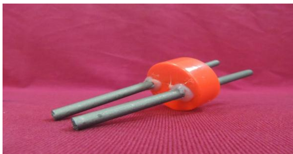
圖 7：2 支碳棒插入蓋子(左)和利用電源供應器進行電解(右)
