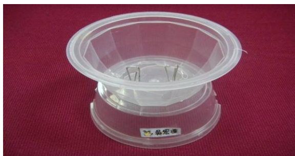
圖 4：迴紋針固定在塑膠盒上(左)和在塑膠盒底部剪成二個倒 V 字(右)
