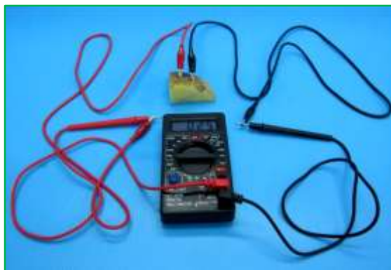
圖 2：測量單一馬鈴薯電池的電壓與電流的示意圖(左)及實際圖(右)
