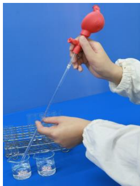
相片五：以 2 mL 刻度吸量管量取 2 mL 唾液澱粉酶溶液
