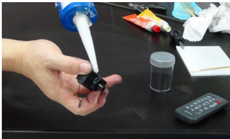
圖 4：印台塗上矽利康固定並防水
