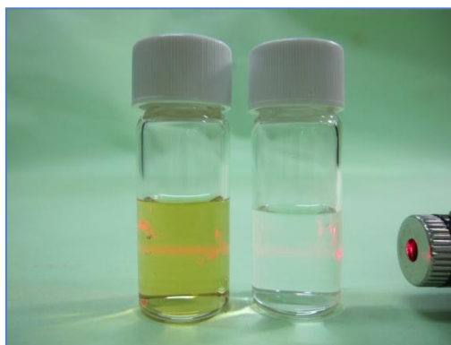
圖 3：銀奈米粒子( 左瓶 )有廷得耳效應，而硝酸銀溶液( 右瓶 )則無。
