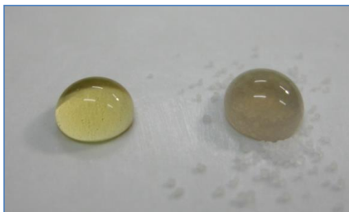
圖 6：銀奈米粒子溶液在蠟層上形成兩顆圓球狀的液滴，左側未加顆粒狀食鹽（黃色），右側有加入顆粒狀食鹽（暗黃色）。
