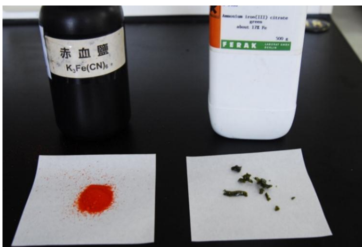
圖 1：紅棕色的固體為鐵氰化鉀 (左) 墨綠色的固體為檸檬酸鐵銨 (右)
