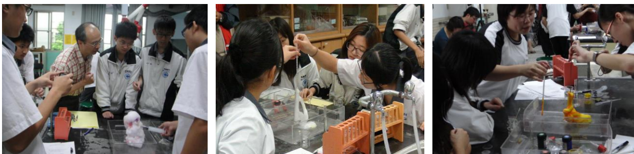
4.注入雙氧水形成小象牙膏（左）、5.測溫（中）、6.用餘燼的線香檢驗 O_2 的存在（右）
