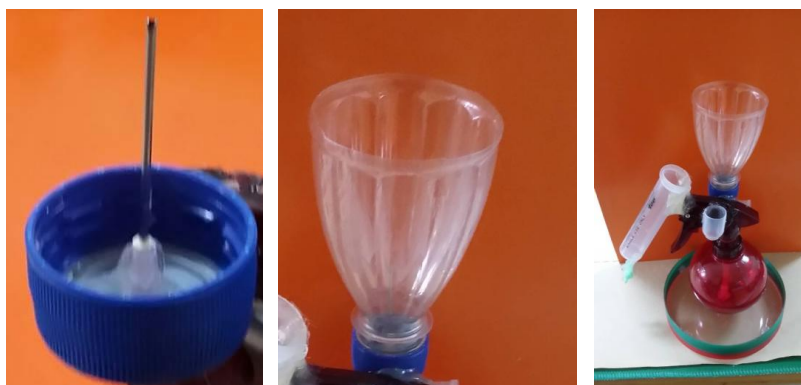
相片十二：供作排水集氣用之塑膠水槽
