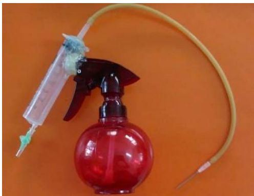
相片九：注射筒下方接上一個雙通塑膠活栓
