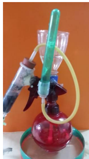
相片十七：導管末端之注射針頭由試管支架下方插入倒置試管之單孔橡皮塞內
