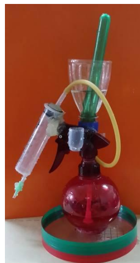
相片十六：將裝滿水之塑膠試管倒插入水槽內之注射針頭中
