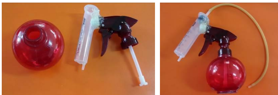
相片五：將塑膠噴霧瓶之噴嘴固定在注射筒之孔洞中
