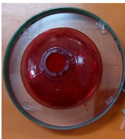
相片七：塑膠噴霧瓶之底部固定黏在塑膠培養皿的中央處
