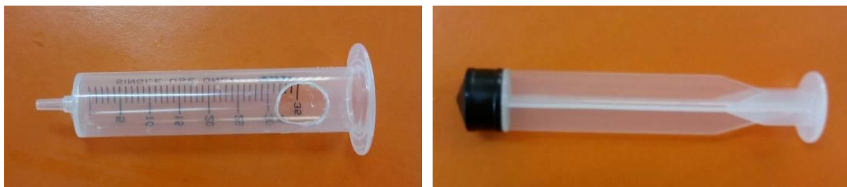
相片四：拔出塑膠注射筒之活塞，並在注射筒上挖一孔洞
