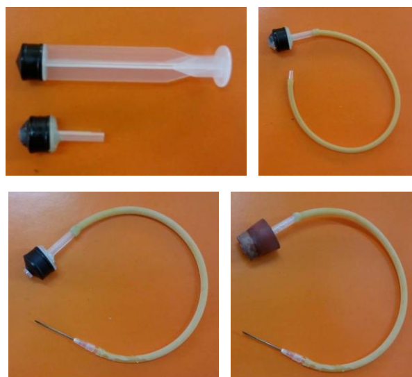
相片八：在反應之導管末端接一支針頭已磨平的注射針頭
