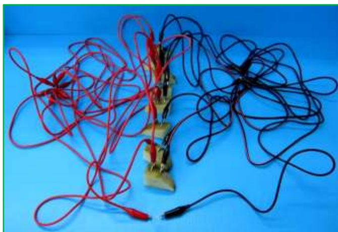
圖 9：測試串聯多個馬鈴薯電池能否使 LED 發光
