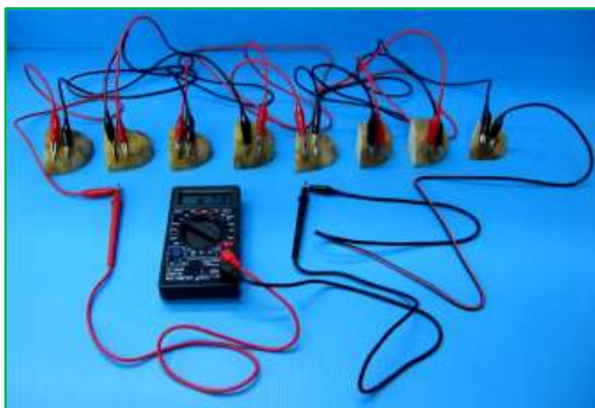
圖4：測量串聯八個馬鈴薯電池的電流與電壓
