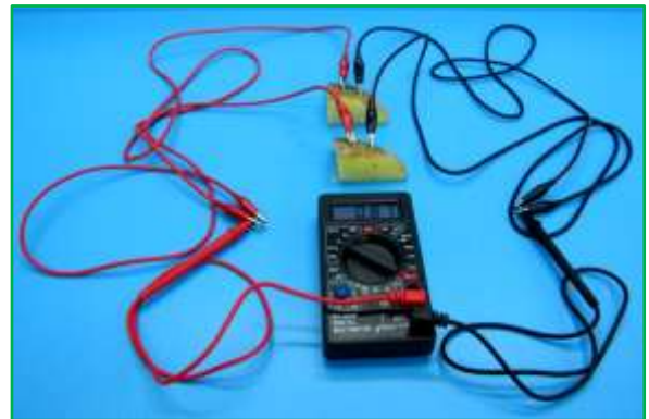
圖 7：測量串聯兩個馬鈴薯電池的電壓與電流的示意圖(左)及實際圖(右)
