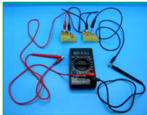
圖 3：測量串聯兩個馬鈴薯電池的電壓與電流的示意圖(左)及實際圖(右)
