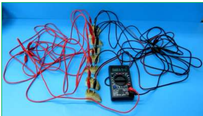
圖 8：測量並聯多個馬鈴薯電池的電流與電壓
