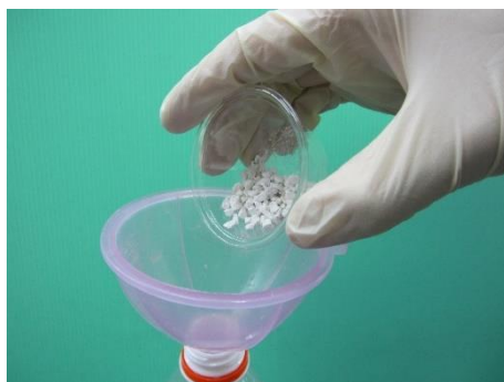
圖 11：在適當時機倒入氧化鈣到寶特瓶中
