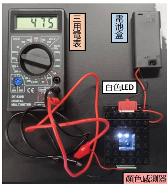
圖 10：以白光 LED 光源及紅色光感測元件做成簡易感測裝置，使用黑色樂高積木製作暗室
