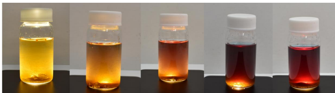
圖 4：以光束從下方通過溶液觀察散射與逐漸變色的現象： 從左到右為二茂鐵(II)變成二茂鐵(III)陽離子的過程
