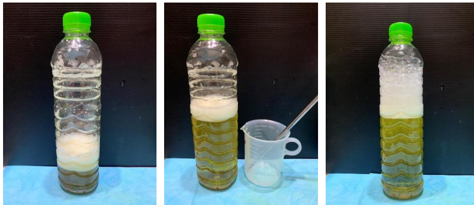
圖 21：先混合均勻精油萃取液和起泡劑（左）；再加水混合（中）；起泡劑較易溶解（右）
