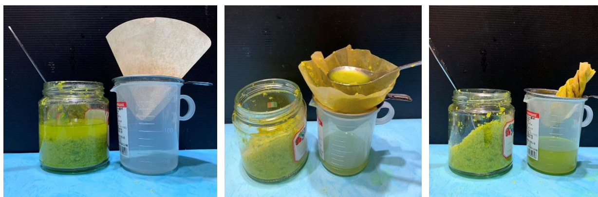
圖 18：準備過濾裝置（左）；轉移萃取液到濾紙中（中）；擠壓濾紙促使溶液流出（右）
