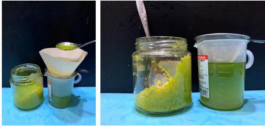
圖 19：轉移含顆粒溶液到濾紙內（左）；過濾幾乎全部的液體（右）
