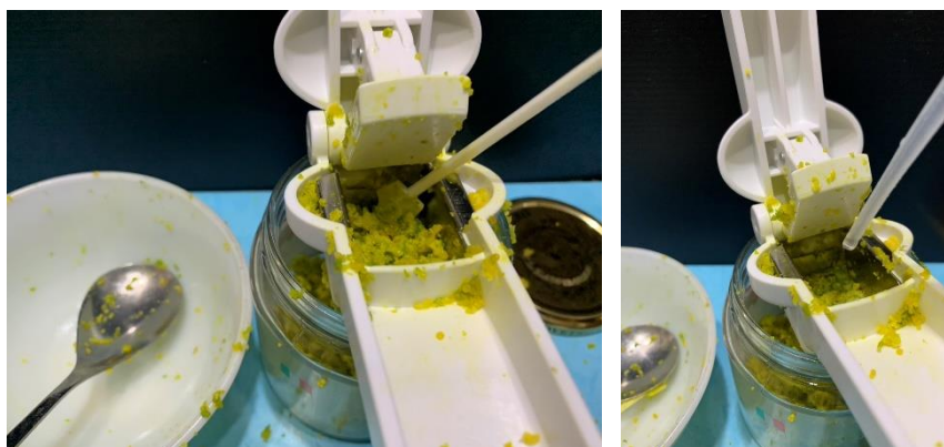
圖 16：用咖啡攪拌棒轉移顆粒（左）；用滴管潤洗壓泥處的顆粒（右）
