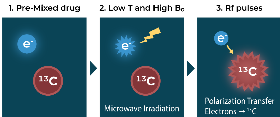
圖 1 此圖說明了動態核極化（DNP）過程中，極化後的自由基（電子）經由微波照射轉移極化到 ^{13}\text{C} 核的過程。
