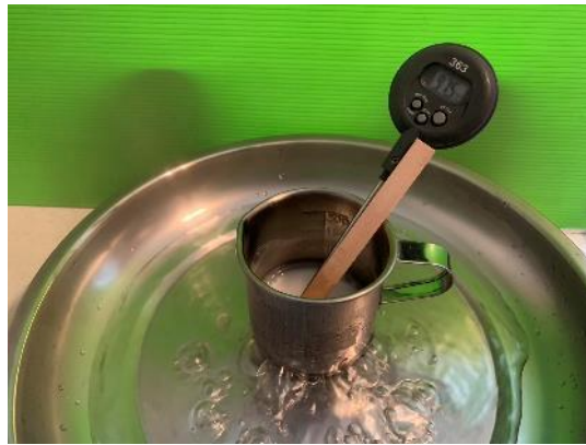
圖 4：放小鋼杯在熱水浴中間接加熱
