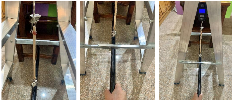
圖 23：粗木棍放在 S 型掛勾上（左）；手握住壓粗木棍並下壓施力（中）；同時注視拉力秤顯示的重量變化（右）
