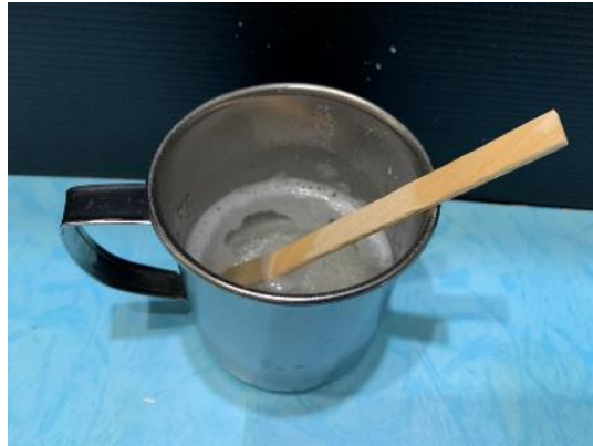
圖 9：在杯中依序加入聚乙烯醇、室溫水及熱水並攪拌之
