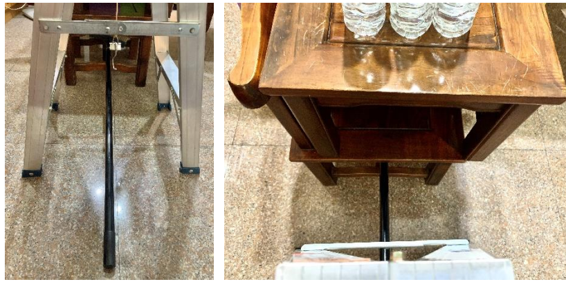
圖 22：放置一支粗木棍在掛勾的下方（左）；粗木棍的一端放在重物的下方（右）
