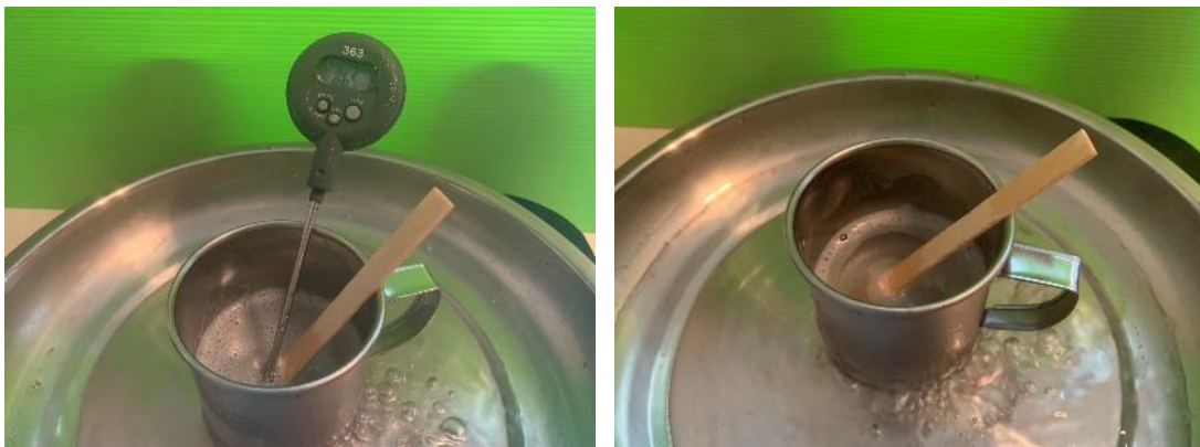
圖 10：內容物在沸騰水中間接加熱
