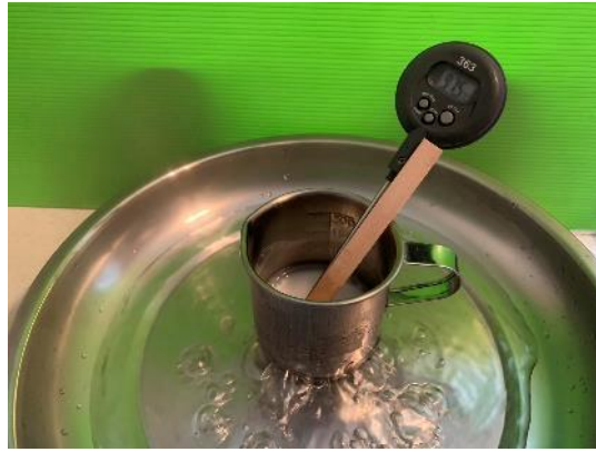
圖 4：放小鋼杯在熱水浴中間接加熱
