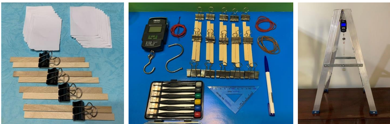
圖 2：測試黏合劑的黏合效果需用器材和材料，定性比較用（左）；定量比較用（中和右）
