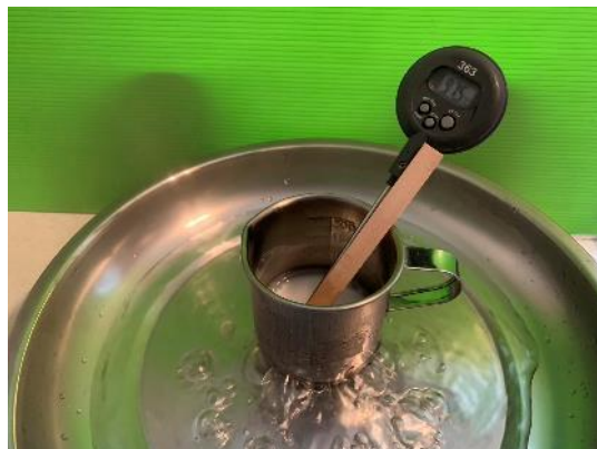
圖 4：放小鋼杯在熱水浴中間接加熱
