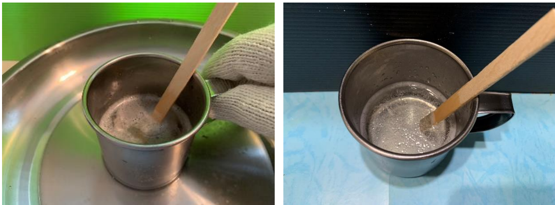
圖 11：戴工作手套取出小鋼杯（左）；趁熱攪拌，靜置後呈現透明的黏稠液體（右）
