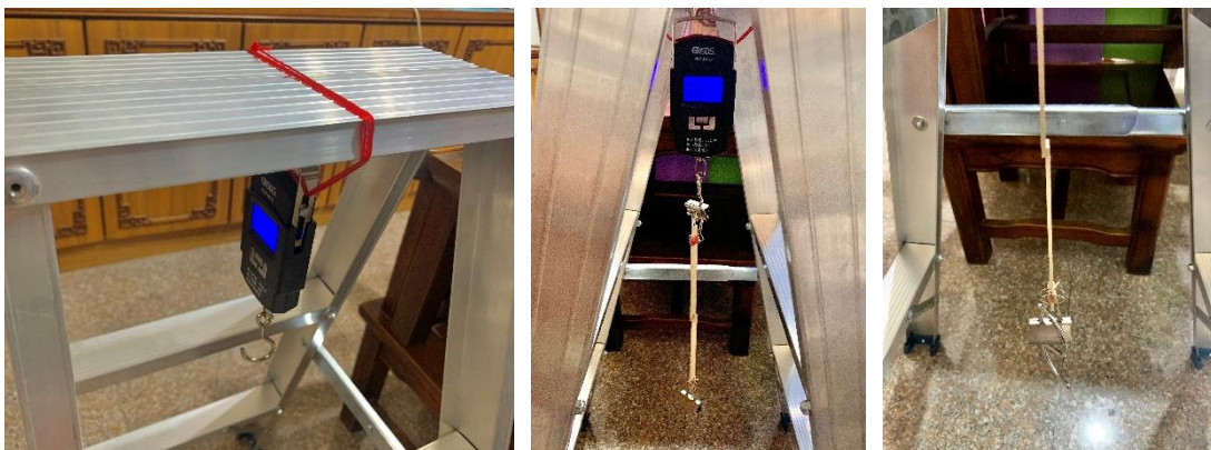
圖 21：拉力秤綁緊在支撐架上(左)；拉力秤的掛勾掛上待測冰棒棍的長尾夾(中)；在下方的長尾夾上，放置 S 型掛勾(右)
