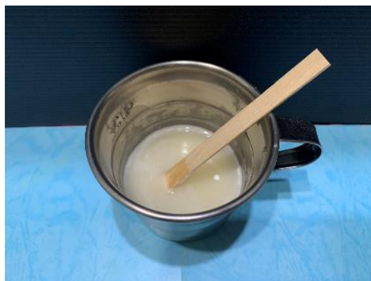
圖 6：在杯中依序加入熱水、玉米粉、蔗糖及阿拉伯膠粉並分別攪拌之
