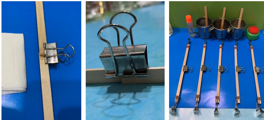
圖 20：成對的冰棒棍塗抹黏合劑後用長尾夾夾緊(左)；黏合成對的冰棒棍成為一條直線(中)；五組測試冰棒棍排列在黏合劑樣品前(右)
