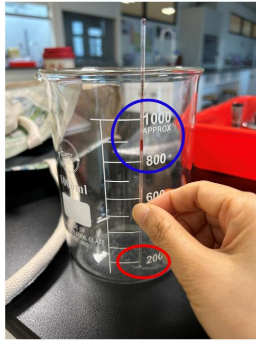
圖 11 毛細管截短後製作的空氣柱當加水至燒杯刻度 1000 mL 時，空氣柱可完全浸入水中。
