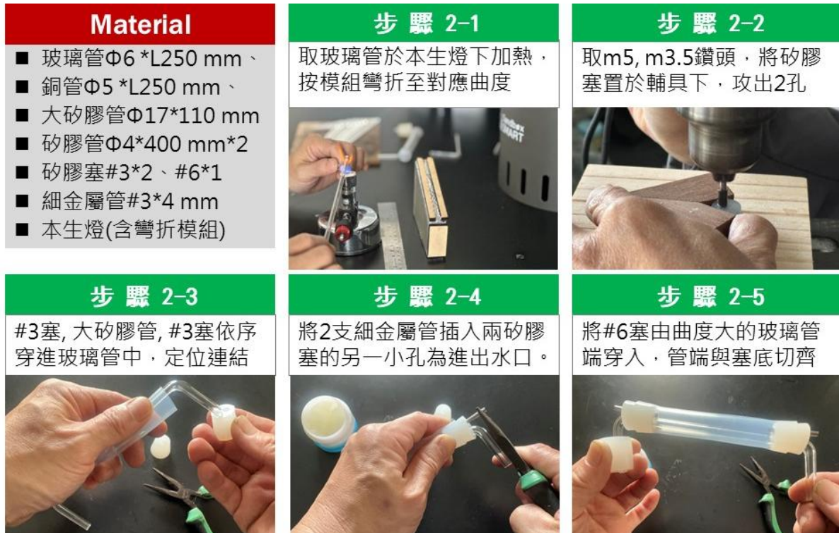
圖 4：冷凝管的製作流程
