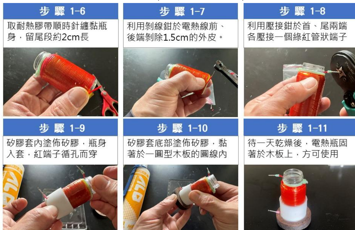
圖 3：電熱式加熱瓶的優化製作流程
