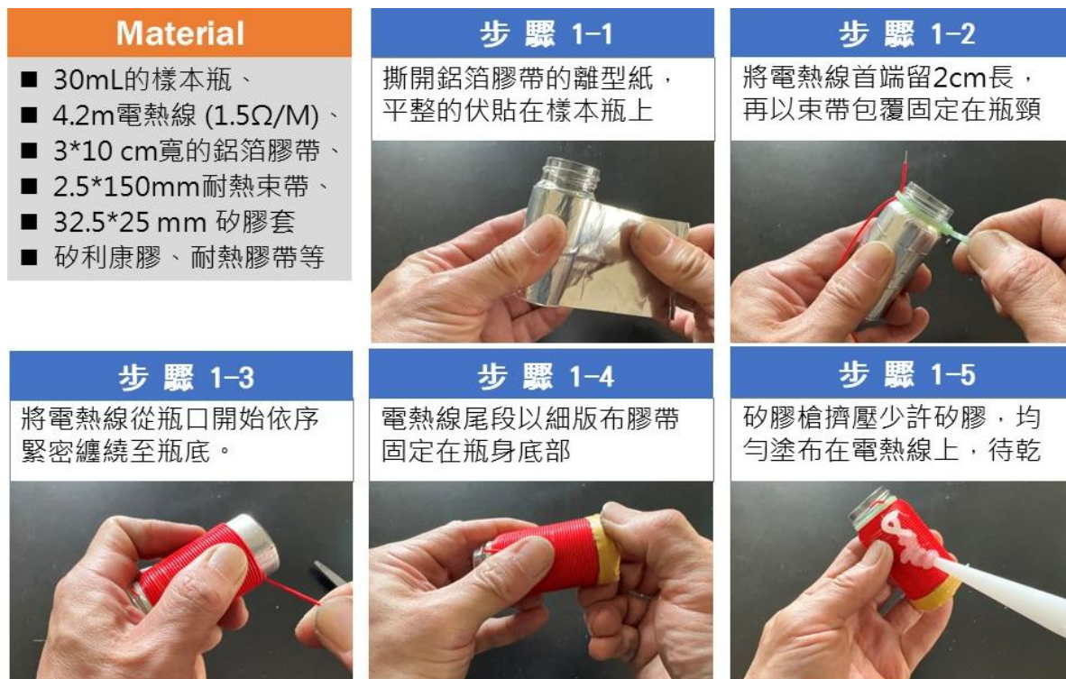
圖 2：電熱式加熱瓶的製作流程
