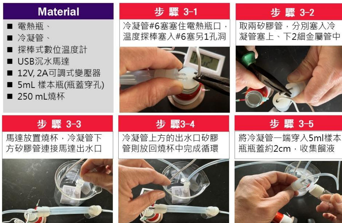
圖 5：迷你型蒸餾器的組裝步驟
