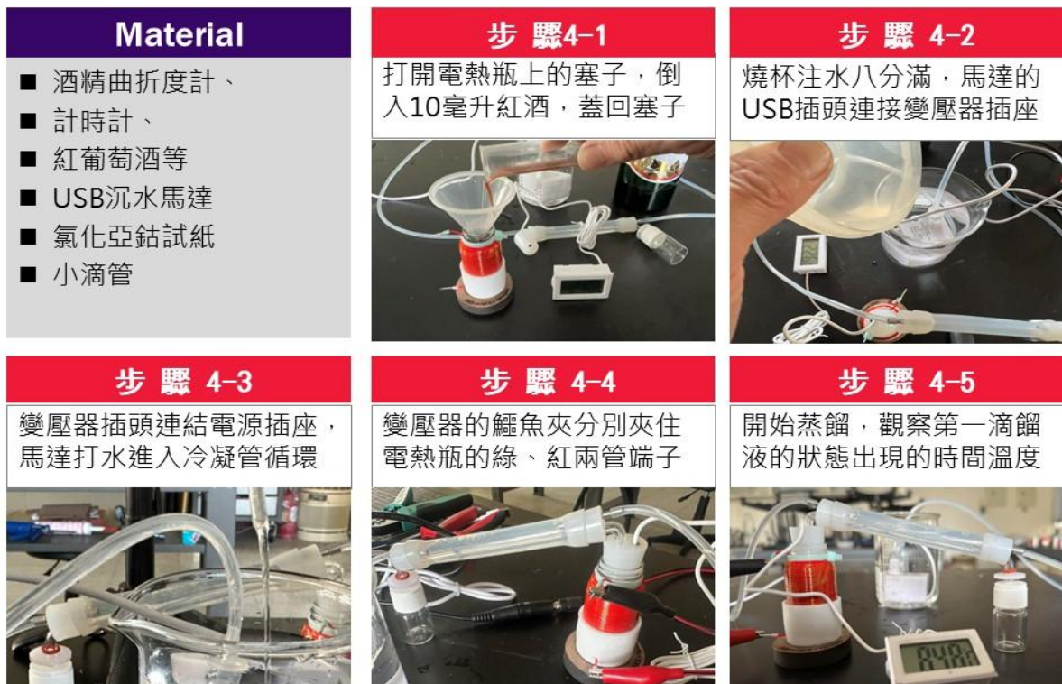
圖 6：蒸餾器的使用步驟流程
