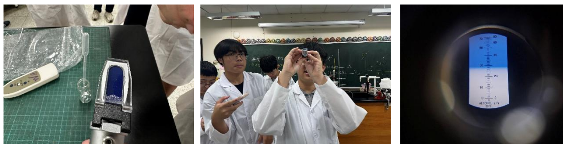
圖 7：酒精度計的外觀操作與測量過程
